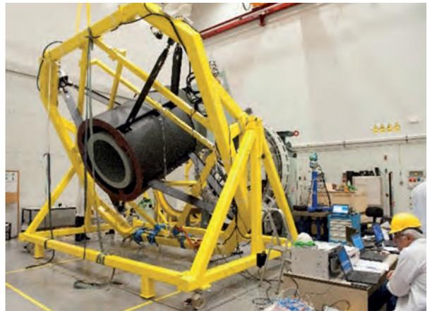
Pruebas en el IAC de la estructura soporte y unidad de traslación del foco (FTS).
