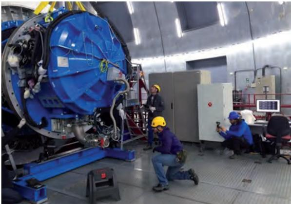
Distintos momentos de las maniobras de anclaje del instrumento en el rotador del telescopio.
