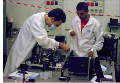
Izquierda: Montaje del goniómetro del banco IFU. Derecha: Instante de las pruebas en la Sala AIV.
