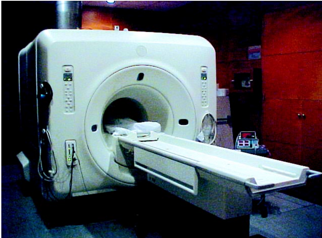
Dispositivo de Resonancia Magnética instalado en el HUC. Permite la obtención de cortes anatómicos con fines diagnósticos así como de imágenes de la función cerebral durante la realización de tareas concretas.
