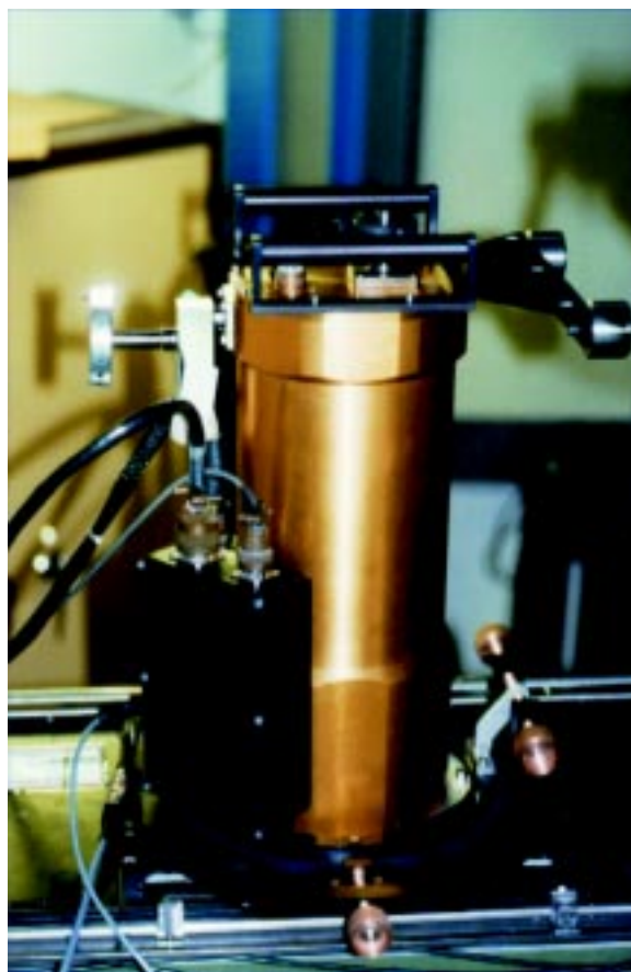
Detalle del criostato que contiene el detector infrarrojo de TIP, instalado en la VTT del Observatorio del Teide.
