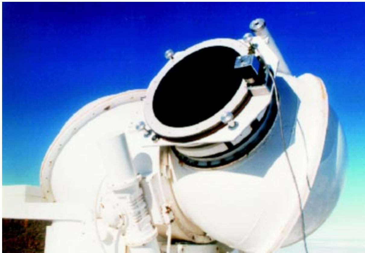
Detalle del telescopio sueco SVST del Observatorio del Roque de los Muchachos (La Palma). Se puede apreciar la presencia de un polarizador lineal, utilizado para calibrar polarimétricamente dicho telescopio.
