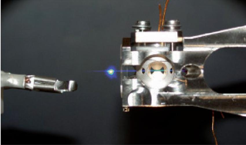
*Detalle de la cámara de vacío. Para el tratamiento de la información cuántica, las partículas individuales como fotones, átomos o iones se utilizan como portadores de información (qubits) que se atrapan en una cavidad óptica manteniéndolos en una posición fija. Crédito: Quantum Dynamics Division - Max-Planck-Institut für Quantenoptik.*
