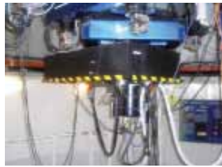
Dos vistas de la nueva caja de A&G del telescopio IAC-80.
