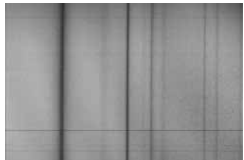
Derecha: Espectro tomado en la región de He I 10830 Å, tras quitar la ventana de salida del tubo de vacío. Se aprecia que la amplitud de las franjas de interferencia ha disminuido, pero todavía queda un patrón residual producido por la ventana de entrada.
