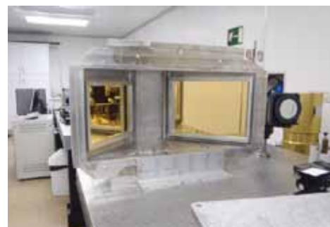
Periscopio de EMIR durante las pruebas de alineado.
