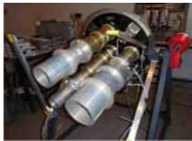
Figura 1 (arriba): Interior del recinto QUIJOTE en el Observatorio del Teide. Figura 2 (abajo): MFI (Multi-frequency Instrument), el primer instrumento para QUIJOTE. Integración final del criostato (mayo-junio 2011).
