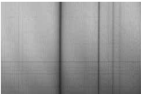
Derecha: Espectro tomado en la región de He I 10830 Å, tras quitar la ventana de salida del tubo de vacío. Se aprecia que la amplitud de las franjas de interferencia ha disminuido, pero todavía queda un patrón residual producido por la ventana de entrada.
