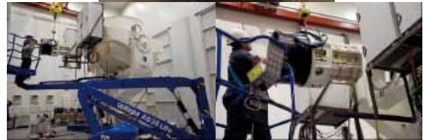
Figura 4: Integración del MFI en el QT-1 (primer telescopio QUIJOTE) en los talleres del IAC.
