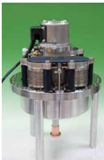
Cabeza fría integrada con una de las monturas antivibratorias.
