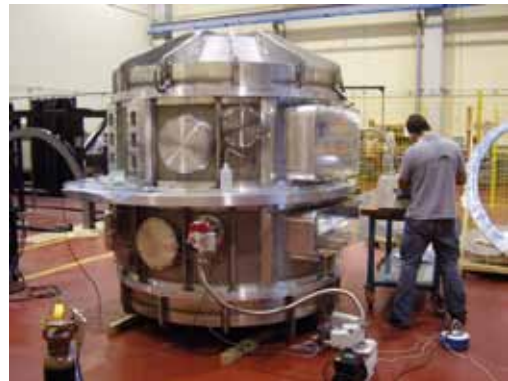
Cámara de vacío durante las primeras pruebas de vacío.
