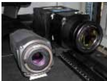
Montaje en el laboratorio de Detectores (LISA) de la cámara comercial con el microbolómetro, para su caracterización.
