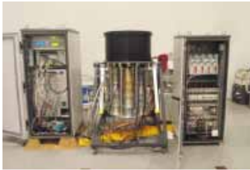
Figura 3: MFI en los talleres del IAC, una vez finalizada su integración. Junto al MFI aparecen dos armarios de electrónica, completamente montados: la electrónica de adquisición (a la izquierda) y la de control de motores (a la derecha).
