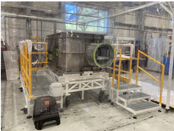
Criostato (incluido el banco óptico y las pantallas de radiación) de FRIDA listo para las pruebas de vacío en CIDESI.
